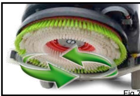
Montez la brosse / le disque sur le mandrin d'entraînement Nulock et faites un mouvement de torsion pour la/le bloquer (fig. 7).
