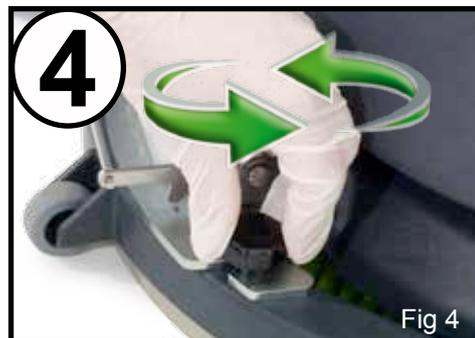
À l'aide des deux boutons de blocage installés sur le suceur, fixez celui-ci sur son support (fig. 4).
