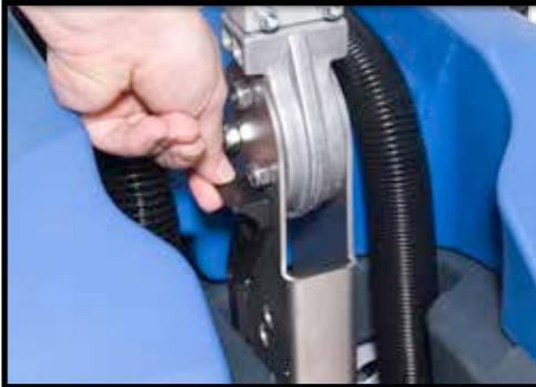
Le support de l'embouchure d'aspiration peut être relevé et bloqué à l'aide du levier, la position haute et basse de ce levier se situe en partie basse du timon.
