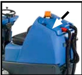
é Un flotteur situé dans le haut de réservoir d'eau sale permet de stopper la machine lorsque celle-ci a atteint son niveau maximum de remplissage.
