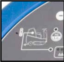
Lorsque le réservoir d'eau sale est plein, un voyant rouge s'allume sur le tableau de bord de l'opérateur (comme illustré) et le moteur d'aspiration s'arrête automatiquement. Le réservoir d'eau sale doit être vidé (voir page 33).
