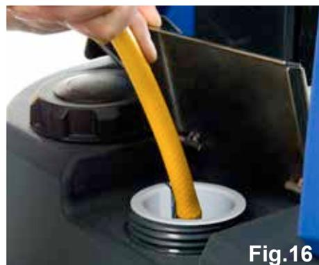
Pour remplir le réservoir d'eau propre, soulevez le rabat (fig. 14) pour exposer le bouchon de remplissage.
