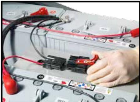
Sous le siège se trouve une prise pour l'isolation du circuit électrique.
