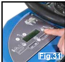
Pour mettre en marche l'aspiration, appuyer sur le bouton d'aspiration à distance situé sur le tableau de bord.
