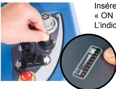
Insérez la clé dans le contact et tournez-la d'un quart de tour vers la droite sur la position « ON » (1).
