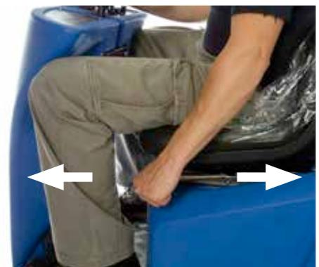
Assis dans la position de conduite, réglez le siège vers avant ou l'arrière si nécessaire en utilisant le levier qui se trouve sur le côté gauche (voir fig. 24).
