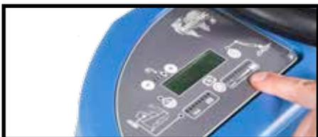
Dès que cette prise est débranchée, l'écran d'affichage indique 'INHIBITED', et la machine est hors fonction.
