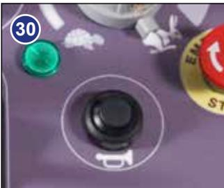
Le klaxon est situé sur le côté droit du tableau de bord de l'opérateur (fig. 30).
