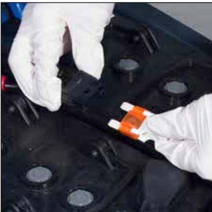
Si la machine doit rester inutilisée pendant une période de 30 jours ou plus, les batteries doivent être au préalable entièrement chargées et les fusibles des batteries retirés avec l'extracteur de fusibles Maxi fourni.
