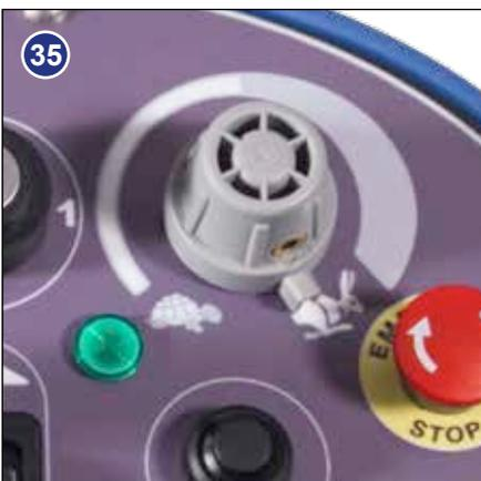
Utilisez la molette de commande de vitesse maximale et réglez la vitesse de traction souhaitée, selon le type de sol et le degré de salissure (fig. 35).
