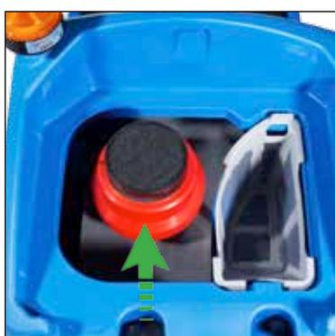
Le système de coupure d'aspiration de la machine arrête le débit d'air lorsque le réservoir supérieur est plein !
