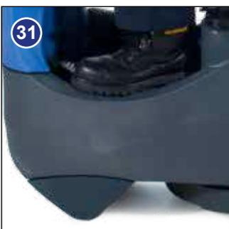
La TTB 2120 est équipée d'un système antibasculement. Si l'opérateur tente de prendre un virage lorsque la machine roule vite, la machine va ralentir automatiquement pour éviter le basculement.
