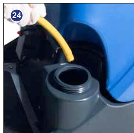
Pour remplir le réservoir d'eau propre, déployez le tuyau Flexifill, retirez le joint en caoutchouc et remplissez en utilisant une arrivée d'eau adaptée (fig. 22). Remettez le joint et le tuyau à leur position initiale lorsque vous avez terminé.
