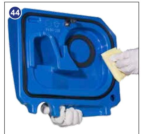
Avant de retirer le séparateur, retirez d'abord le tuyau branché (fig. 42). Retirez le séparateur et rincez-le à l'eau claire (fig. 43). Le séparateur possède aussi un joint en caoutchouc qui doit être examiné à chaque nettoyage (fig. 44).
