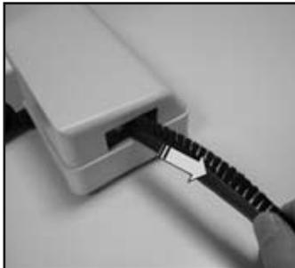
**ATTENTION:** avant de procéder avec cette opération, éteindre l'appareil et le débrancher. À l'aide d'une monnaie ou d'un tournevis à tête plate, desserrer complètement la vis de fixation du couvercle Q. À l'aide d'un outil (par ex., pince à bec) extraire complètement le strip à poils usé et le remplacer par un nouveau, et procéder à l'inverse pour le remontage.
